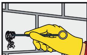
3. El orificio de perforación debe limpiarse a fondo con el cepillo de acero especial (cepillar al menos 2 veces). El diámetro del cepillo debe ser mayor que el diámetro del orificio de perforación.
