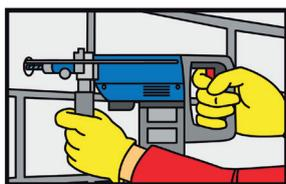
1. Perfore el agujero con un taladro eléctrico hasta el diámetro y la profundidad requeridos. El diámetro del orificio de perforación debe ser conforme al tamaño del anclaje
