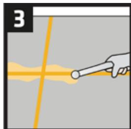
Luego de las 6 horas, use un elemento cortante para limpiar el exceso de material. Si la temperatura es baja, puede requerirse más tiempo de espera antes de quitar el exceso.
