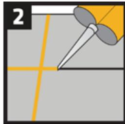
Proceda a rellenar la junta con el producto procurando no excederse de la misma para evitar ensuciamiento de la placa.
